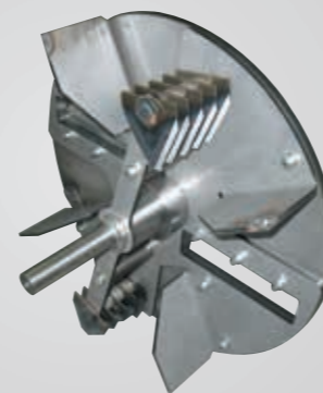
Rotore di triturazione con lama di pretaglio e martelletti mobili posteriori
