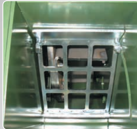
Vaglio di raffinazione regolabile Adjustable refining sieve Crible de raffinage réglable Einstellbares Sieb zur Verfeinerung Tamiz de refinamiento regulable Instelbaar rooster om de fijnheid te regelen Регулируемое сито очистки
